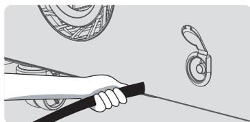
El freezer cuenta con un desague en la espalda, útil en el caso de un derrame en el interior que se puede dar por deshielo al desconectar y/o por limpieza de la unidad.
