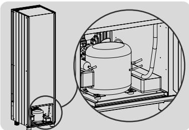
La exhibidora tiene una bandeja de desagüe en la parte inferior. Cuenta con una serpentina para evaporar el agua recolectada debido al descarche del evaporador.
