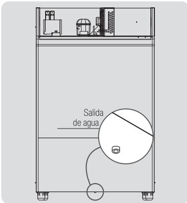
Las exhibidoras Inelro, no necesitan ser descongeladas, dicho proceso se realiza en forma automática. Por tal motivo es fundamental que el orificio de purga de agua señalado en el interior de la unidad quede libre de obturaciones.
