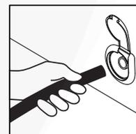
Nunca se debe limpiar el equipo con chorros de agua, como ser de mangueras o hidrolavadoras. No utilice productos solventes o abrasivos para limpiar la unidad. En el caso de un derrame importante, la unidad cuenta con un desagüe frontal que está provisto de un pico para conectar una manguera (Ø13mm) y de esta forma desagotar el interior del equipo más fácilmente.
